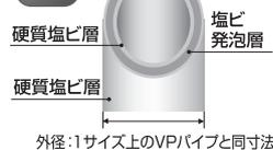
外径:1サイズ上のVPパイプと同寸法
